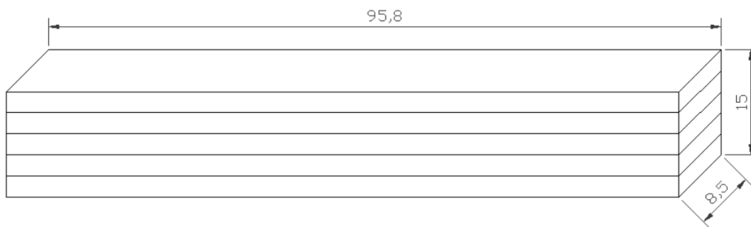
FIGURA 4.1 – Dimensões da viga de madeira laminada colada.
